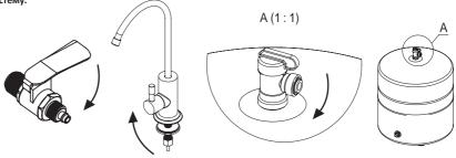
16. После того как бак наполнится (вы услышите, что поток воды остановится), слейте воду из бака в канализацию, открыв кран очищенной воды 3. После того как напор воды исчерпается, закройте кран очищенной воды 3, чтобы бак снова начал наполняться. В зависимости от давления в вашей водопроводной системе, наполнение может занять от 1,5 до 3 часов. После того как бак наполнится во второй раз, вы можете пить очищенную воду.
